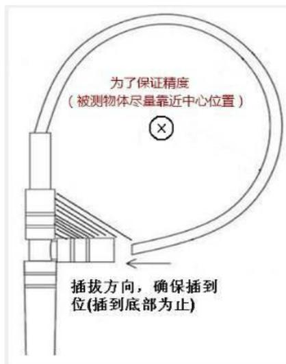
注：图中阴影区域误差最大，被测导线应尽量避免该区域
